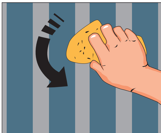
Limspill på framsidan av tapeten måste genast tas bort försiktigt med en mjuk, blöt tapetsvamp.
