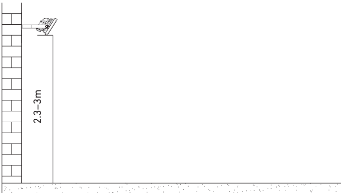
Fig 2. Montageanleitung LED-Scheinwerfer (ohne Bewegungsmelder)
