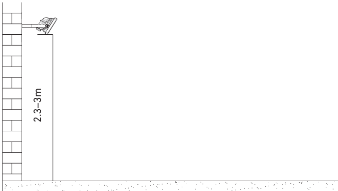
Fig 2. Monteringsanvisningar Strålkastare LED (utan rörelsedetektor)
